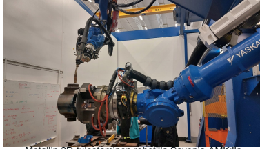
Metallin 3D-tulostaminen robotilla Savonia-AMK:lla
